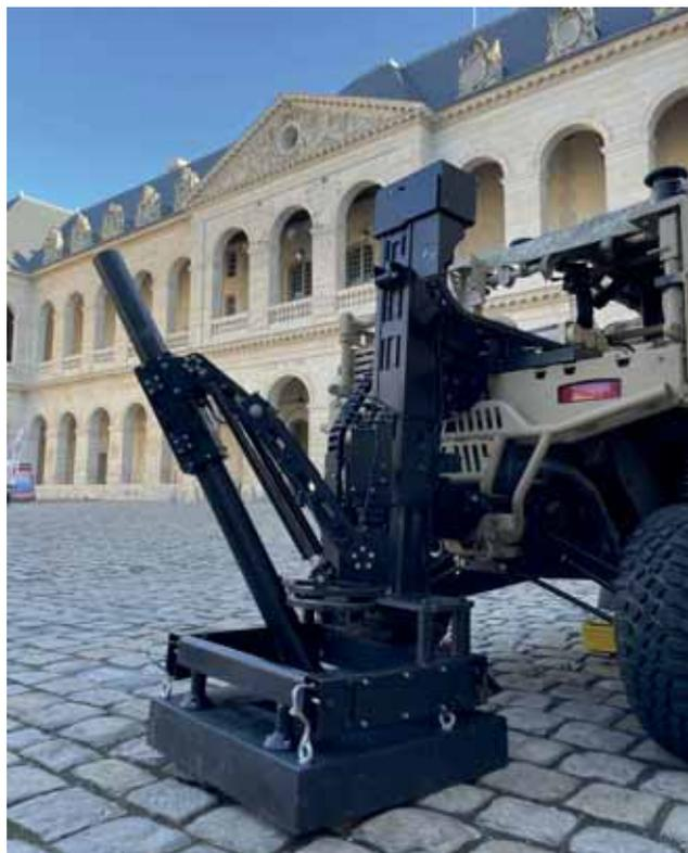
lui livrer des systèmes ALAKRAN, c'est-à-dire un porte-mortier de 120 ou de 81 mm à visée automatique qui ne nécessite pas de mécanisme d'absorption de recul.
